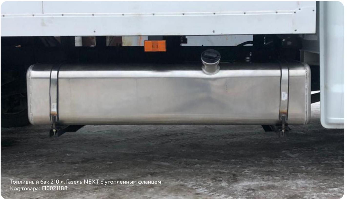
Топливный бак 210 л. Газель NEXT с утепленным фланцем
