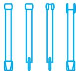
Это металлические ленты, с помощью которых бак притягивается к кронштейнам. Способы крепления хомутов к кронштейнам могут быть разными в зависимости от профиля бака, материала изготовления бака, а также применяемости по марке и модели. Могут быть изготовлены как из обычной стали толщиной 1,5 мм с гальванированным покрытием, так и из нержавеющей стали толщиной 1,5 мм.
