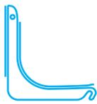
Это силовые элементы, выполненные из листа стали толщиной от 3 мм, которые несут всю нагрузку как собственного веса бака, так и топлива, содержащегося в нем. Традиционно, кронштейны поддерживают бак снизу. Но баки на автомобили Газель с профилями 235x380 мм и 243x383 мм подвешиваются к кронштейнам сверху. Кронштейны окрашены полимерно-порошковой краской.
