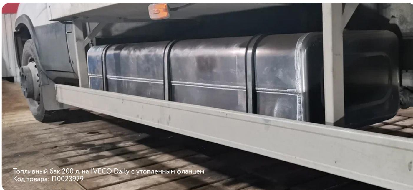
Топливный бак 200 л. на IVECO Daily с утепленным фланцем
