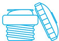
Предназначены для запираения заливной горловины бака. Бывают разной конструкции: с клапаном и без клапана, резьбовые, полуоборотные, стальные и пластиковые. У разных баков – разные крышки. Например, у баков для Газель с инжекторным или дизельным двигателем – пластиковая резьбовая крышка, а у баков для а/м с карбюраторным двигателем – железная полуоборотная.
