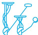
Устройства, предназначенные для измерения уровня топлива в баке. Представляют собой поплавков на спице, который, поднимаясь или опускаясь, меняет сопротивление на специальном датчике, который передает показания на приборную панель. Современные погружные модули уже оснащены датчиком уровня топлива. Но на некоторых топливных баках, как, например, Валдай или Газель 33023 с карбюраторным двигателем, используются классические датчики уровня топлива
