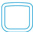
Профиль габаритами 670×700 мм (В×Ш) традиционно используется для производства алюминиевых баков для европейских грузовиков Scania. Отличительной особенностью данного профиля является то, что нижние углы профиля имеют больший радиус по отношению к верхним углам профиля. Кстати, для производства а/м Камаз NEO в период с 2017 по 2018 г. применялись топливные баки объемом 695 л. именно этого профиля.
