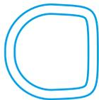
D-образный профиль размерами 710×690 мм (В×Ш) используется для производства алюминиевых топливных баков грузовых а/м VOLVO и RENAULT. Объем баков данного профиля варьируется от 300 до 850 л. Кронштейны и ленты с креплениями для данных баков подойдут и для баков круглого профиля диаметром 710 мм.
