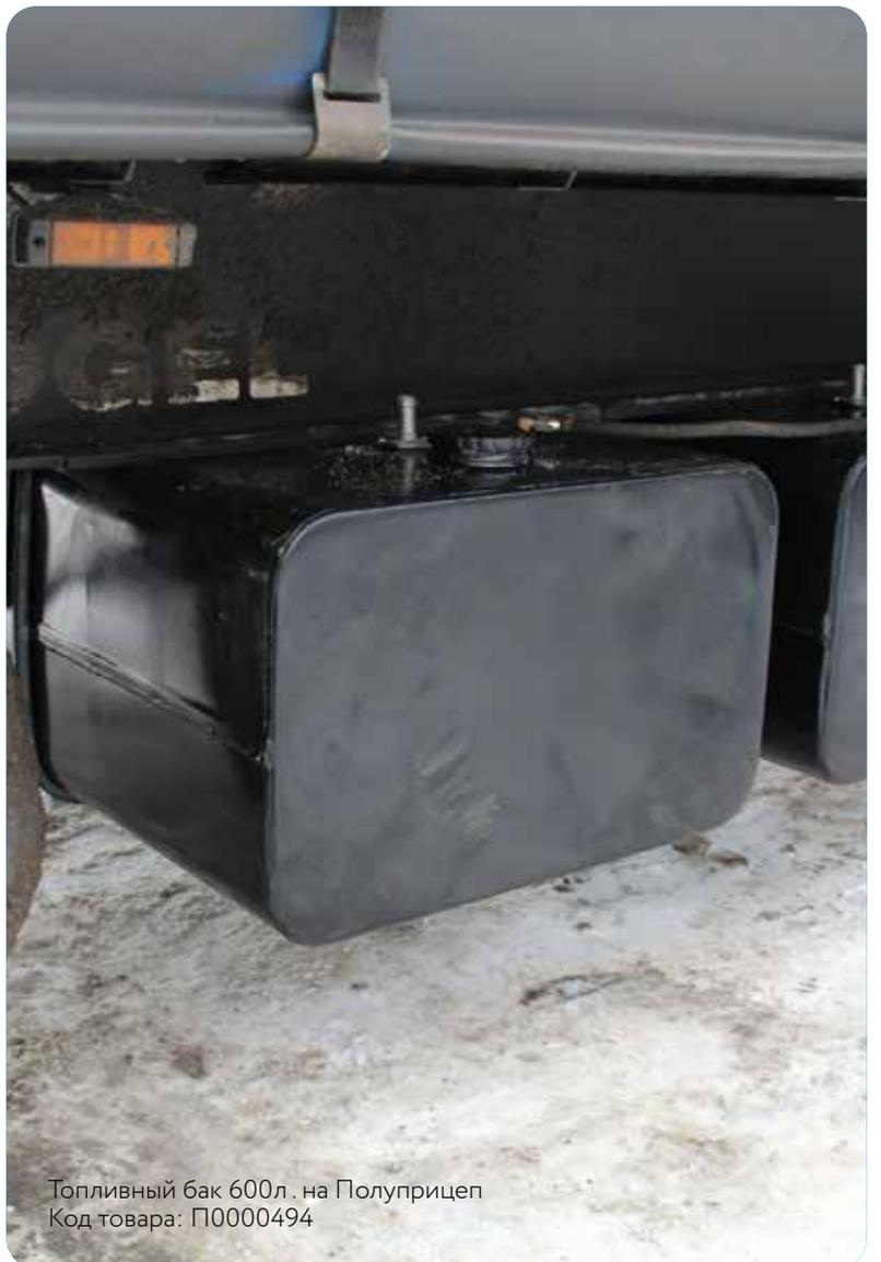
Топливный бак 600л. на Полуприцеп
