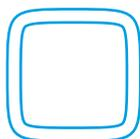
Алюминиевые топливные баки профиля 700×700 мм встречаются на многих европейских грузовых а/м, таких как Mercedes-Benz, MAN, DAF. Даже на некоторых моделях Камаз NEO. На сегодняшний день — это самый большой профиль в линейке БАКОР, применяемый для изготовления топливных баков. Кронштейны к бакам данного профиля идут усиленные.
