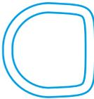
D-образный профиль размерами 710×690 мм (В×Ш) используется для производства алюминиевых топливных баков грузовых а/м VOLVO и RENAULT. Объем баков данного профиля варьируется от 300 до 850 л. Кронштейны и ленты с креплениями для данных баков подойдут и для баков круглого профиля диаметром 710 мм.
